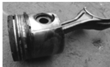
图4 活塞环严重磨损
