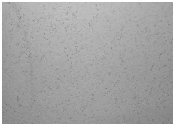
图2 轧辊氧化膜剥落缺陷
